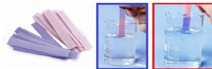
Слика: Понашање плавог лакмус папир у киселини и црвеног у бази
